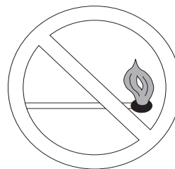
Fig. 6 – Ne pas allumer les brûleurs avec une allumette
